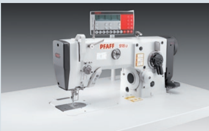
PFAFF 918-49/01 oder 918-47/12 - Zickzack-Schnellnäher mit Untertransport und großem Greifer um Kante an Kante zu nähen
