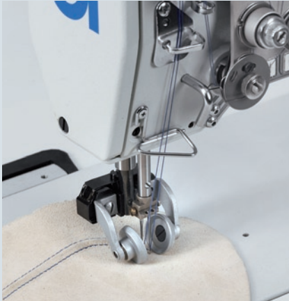
Wulstnaht im Blattbereich Cording seam on vamp
