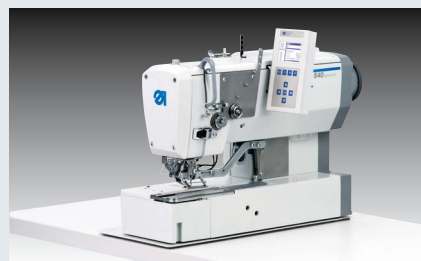
Dürkopp Adler 540-100-01 – CNC gesteuerter Doppelstepstich-Knopflochautomat (~ 800 Knopflochleisten mit je 6 Knopflöchern in 480')
