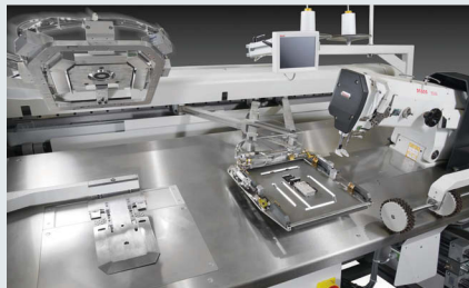
PFAFF 3588-12/021 – Nähanlage zum automatischen Umbuggen und Aufnähen von Hemdentaschen, optional mit oder ohne Patte (~ 2.400 Hemdentaschen in 480')
