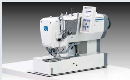
Dürkopp Adler 540-500-01 – CNC gesteuertes Doppelsteppstich-Knopflochautomat mit separat angetriebenem Messer für verlängertes Schneiden bis zum Knopflochriegel (~ 4.000 Stiche/Min.)
