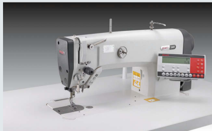
PFAFF 2483 – Einnadel-Doppelsteppstichmaschine mit Untertransport und Sensorik zur Erkennung der Stofflagen mit automatischem Setzen des Eckstichs (~ 600 Ärmelschlitzte in 480')
