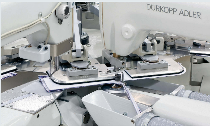
Spezialmaschinen für die Manschetten- und Kragenfertigung Special machines for processing of cuffs and collars
