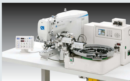
Dürkopp Adler 550-532 – Doppelsteppstich-Knopfannähautomat mit automatischer Knopfzuführung (~ 2.400 Hemden mit 7 Knöpfen auf der Leiste)
