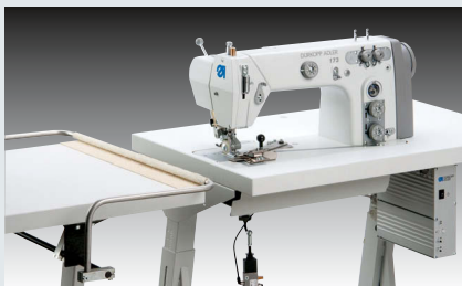
Dürkopp Adler 173-141610 (550-15-5) – Optimierter Arbeitsplatz mit Doppelkettenstichmaschine mit Puller und Bündelklemme für das Annähen und Übersteppen der Rückenpasse (~ 1.000 Rückenpassen in 480')
