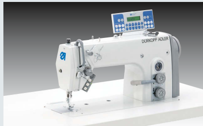
Dürkopp Adler 272-140342-01 – Einnadel-Doppelsteppstichmaschine mit Unter- und Nadeltransport (~ 450 Paar Ärmelschlitzte in 480')
