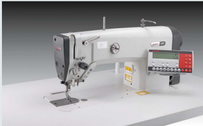
PFAFF 2483 – Einnadel-Doppelsteppstichmaschine mit Untertransport und Sensorik zur Erkennung der Stofflagen mit automatischem Setzen des Eckstichs (~ 1.400 Etiketten in 480')
