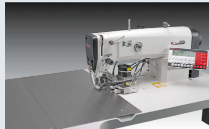
PFAFF 3511 – Doppelsteppstich Nähautomat zum Vornähen und gleichzeitigem Beschneiden von Kleinteilen durch Schablonensteuerung (~ 1.600 Manschetten in 480')
