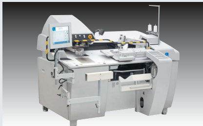
Dürkopp Adler 806N-121-01 – Nähanlage zum automatischen Umbuggen und Aufnähen von Hemdentaschen, optional mit oder ohne Patte (~ 2.400 Hemdentaschen in 480')
