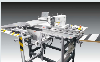
PFAFF 3586 – Doppelstepstich Nähautomat für Abnäher bis zu 490 mm Abnäherlänge (~ 2.700 zweispitzige Abnäher in 480')
