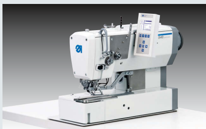
Dürkopp Adler 540-500-01 – CNC gesteuerter Doppelstepstich-Knopflochautomat mit separat angetriebenem Messer (~ 800 Knopflochleisten mit je 6 Knopflöchern in 480')
