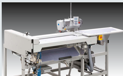
Dürkopp Adler 841-01 – Knopfloch-Indexer für Hemden- und Blusen-Vorderteile (~ 1.200 Knopflochleisten mit je 6 Knopflöchern in 480')
