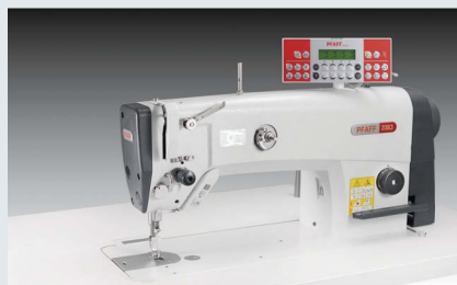
PFAFF 2083 – Einnadel-Doppelstepstichmaschine mit Untertransport zum Ärmelinnähen (~ 420 Hemden in 480')
