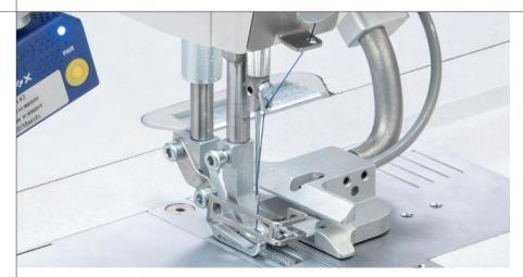
Kantenlineal mit integrierter Zwickerkennung inkl. Lichtleiter und Auswerte-Elektronik zur Identifikation eines positives Zwicks im Material während des Nähprozesses
