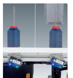
Prüfung und Dokumentation der Nähgarne und Spulen – Stationäre Scanner (Matrix 120-000) zur Spulen-Identifikation mittels Barcode / QR-Code am Spuler und über dem Greiferbereich und weitere Scanner zur Faden-Identifikation mittels Barcode / QR-Code unterhalb der Fadenkone
