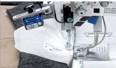
**Scanner für Endlabel-Erfassung** des fertig genähten Teiles mit Datenspeicherung aller Informationen zu diesem Nähprozess
