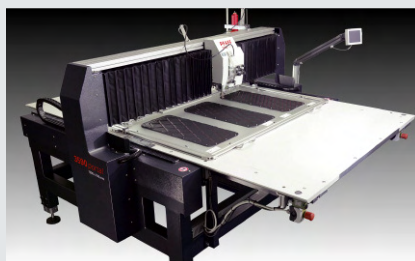
PFAFF 3590 Portal – CNC-gesteuerte Nähanlage mit Klammersystem zur Herstellung großflächiger Applikationen
