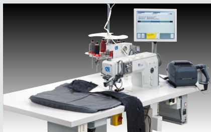
Dürkopp Adler 550-867 – Gestalteter Arbeitsplatz für dokumentiertes Nähen von Airbag-Sollreißnähten
