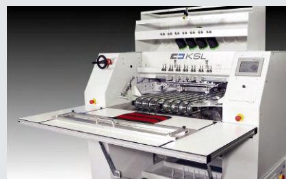
KSL 960 – Vielnadel-Nähanlage mit linearem Nadelantrieb zum geradlinigen Durchnähen von Einzelzuschnitten oder Rollenware mit mehreren Nähwerkzeugen in einem Arbeitsgang
