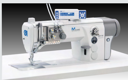
Dürkopp Adler 867 PREMIUM – Ein- oder Zweinadel-Flachbettmaschine mit integriertem Direktantrieb und programmierbaren Stellelementen
