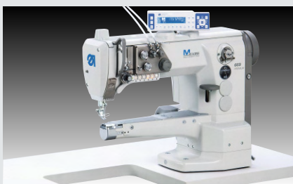
Dürkopp Adler 669 PREMIUM – Einnadel-Freiarmmaschine mit integriertem Direktantrieb, Horizontalgreifer und programmierbaren Stellelementen
